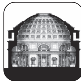
Dibujo en corte del Panteón de Roma.
